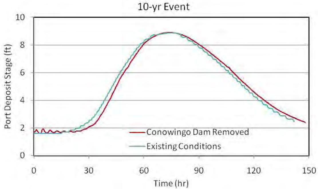
**FIGURE 3.3-1: ALTERNATIVE ONE-PORT DEPOSIT STAGE TIME SERIES COMPARISON**
